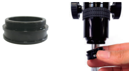
補助レンズはレンズの先端に取り付けます。
