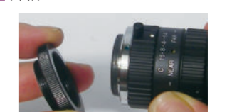
固定焦点レンズに5mmの接写リングを装着
