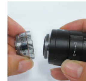
固定焦点レンズに x2のエクステンダーを装着
