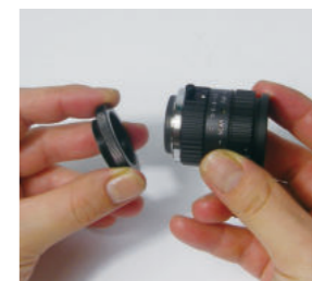
固定焦点レンズに 5mmの接写リングを装着
