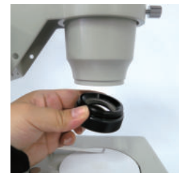
補助レンズは対物レンズの先端に付けます。
